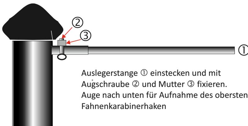
Auslegerstange ① einstecken und mit Augschraube ② und Mutter ③ fixieren. Auge nach unten für Aufnahme des obersten Fahnenkarabinerhaken
